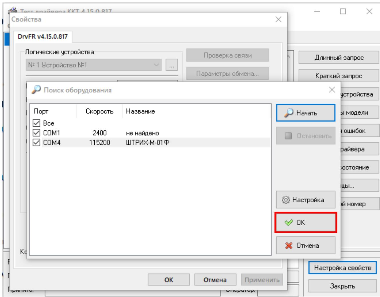
Окно "Поиск оборудования" закроется. В окне "Свойства" нажмите кнопку "Проверка связи"
